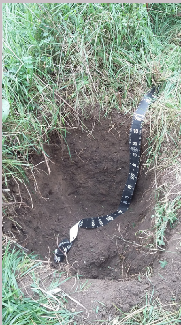
Ouverture de profils pour analyser la composition des sols, l'activité biologique et le développement racinaire des végétaux, à Aulnay-sous-Bois. / Robin Dagois, Plante & Cité
